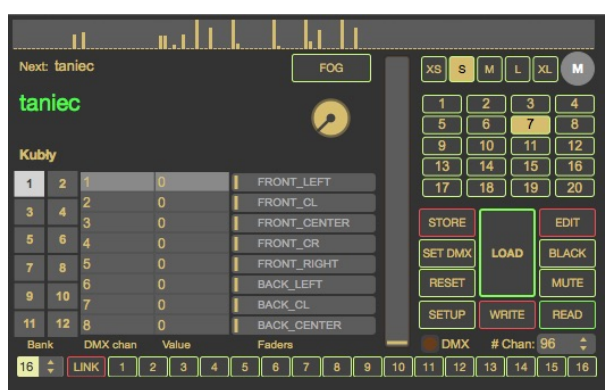
Rys. 21 Jeden z modułów programu Flimp odpowiedzialny za sterowanie urządzeniami DMX (światło i maszyna do dymu)
