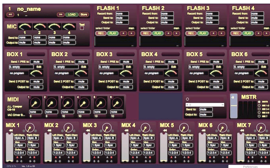
Rys. 11 Okno programu DSP Shelf. Cztery rejestratory ( Flash ), sześć bloków przetwarzających ( Box ) oraz siedem niezależnych wyjść torów kwadrofonicznych ( Mix ).
